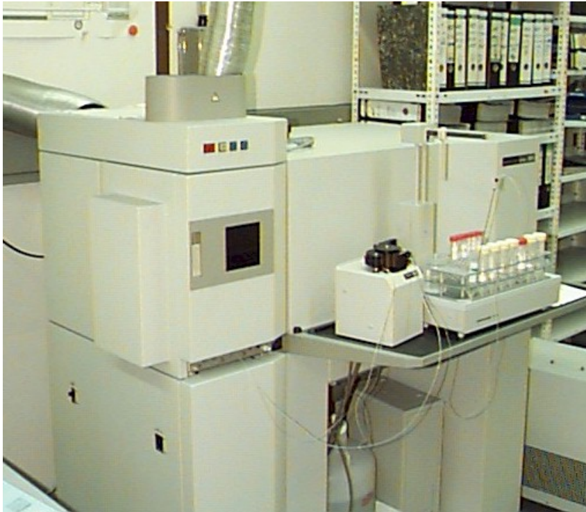
Fig. 1: Instrumentierung zur Multielementanalyse mittels ICP OES
